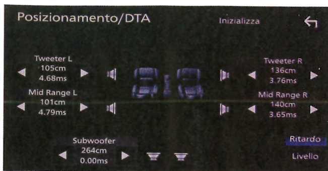
Un completo DSP è presente all'interno della head unit Kenwood che permette di configurare le uscite anche per pilotare un sistema a due vie più sub, offrendo un versatile crossover digitale.
